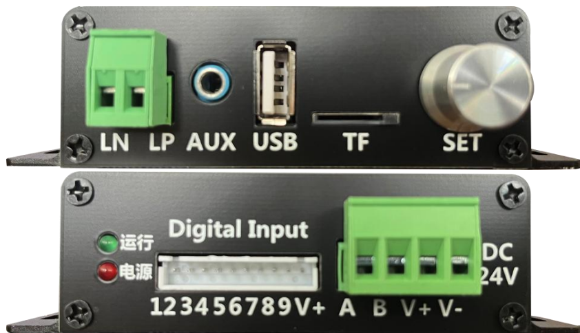
图 3 Modbus 语音播放器硬件接口实图
