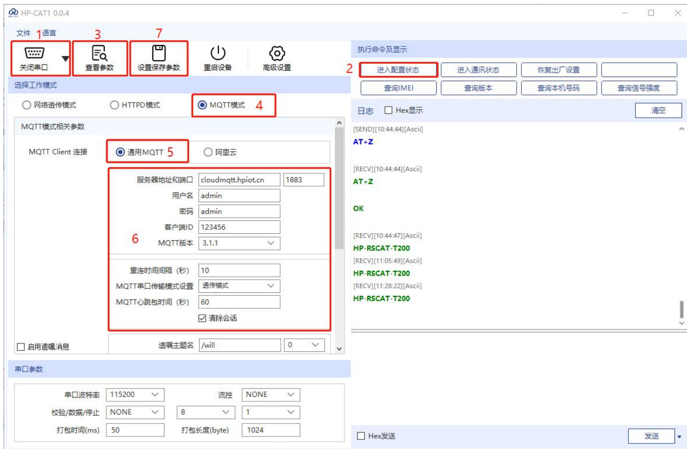
图 9 设置软件 MQTT 模式示意图
