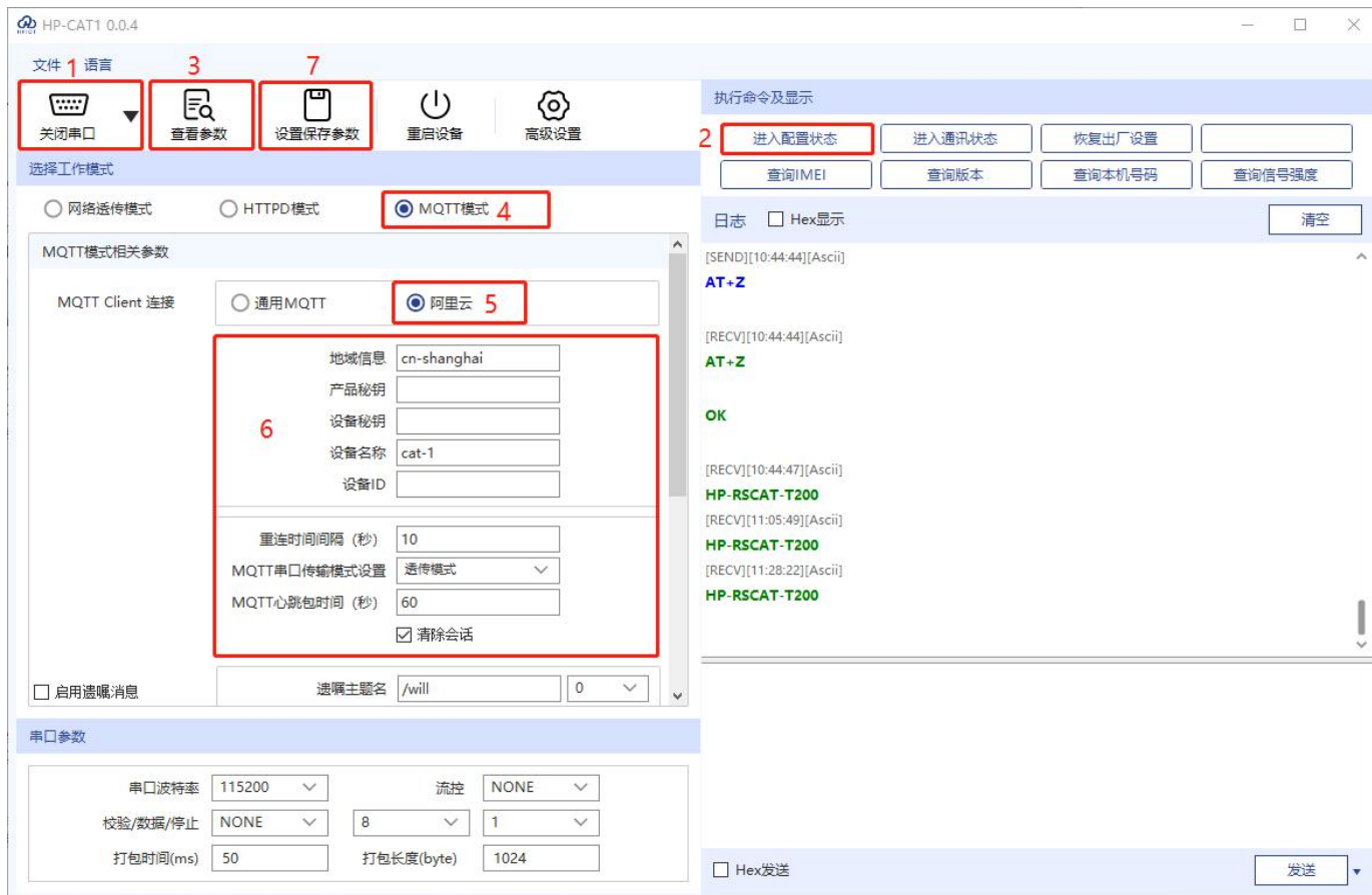
图 11 MQTT 模式阿里云接入示意图
